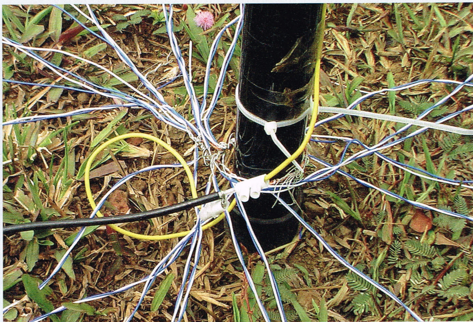
Aardnet van een vertical, met de straler met kroonsteentjes aangesloten op de coaxkabel
